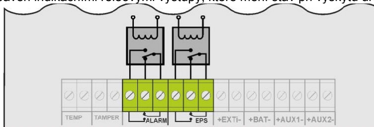
Obr. 5. Elektrické schéma reléových výstupů.
