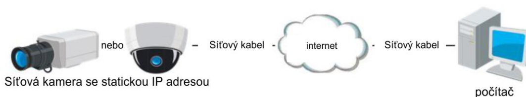
Obrázek 2–11 Přímý přístup ke kamere se statickou IP adresou
