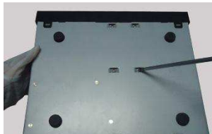
④ Otočte DVR a HDD přišroubujte.
