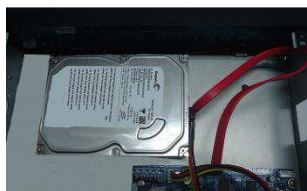
⑤ Připojte napájecí a datové kabely.
