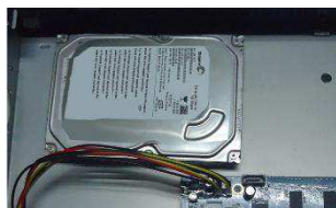
③ Umístěte HDD na dno DVR.
