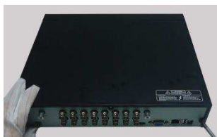
① Odšroubujte a sejměte vrchní kryt DVR.
