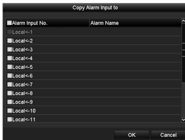
Obrázek 5.16 Kopírování vstupu alarmu
